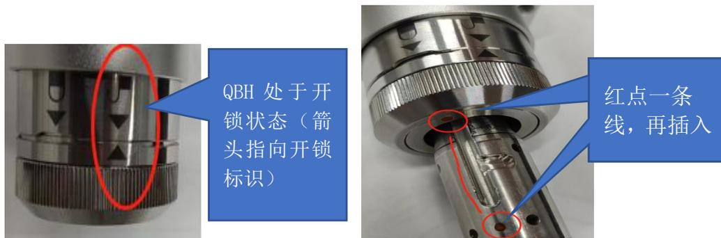
5.2 顺时针旋转 QBH 接头上带锁标识的环,直到 QBH 处于关锁状态（箭头指向关锁标识），最后扭紧锁紧环即可。
