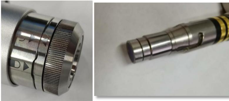
5.2 QBH 处于开锁状态（箭头指向开锁标识），光纤插头红点对准 QBH 端面红点插入到位;
