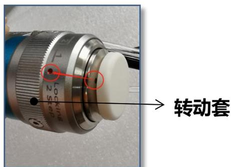
**第二步：**用无尘清洁棒和无水乙醇清洁光纤棒头部、及QBH接头。
