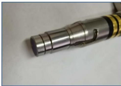
第二步：QBH处于开锁状态（箭头指向开锁标识），光纤插头红点对准QBH端面红点插入到位；
