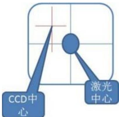
在工作过程中，CCD图像中心（十字架交叉点）必须与激光中心重合。
