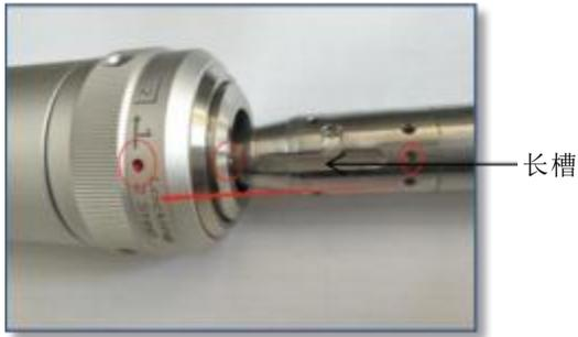
**第四步：**光纤头插入QBH后，用手提起转动套，直至 转动套底面基本与QBH顶部平齐，再顺时针方向旋转转动套至光纤头卡槽锁紧即可。转动力度应适中。
