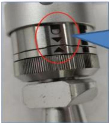
顺时针旋转本件，直到QBH处于关锁状态（箭头指向关锁标识）
