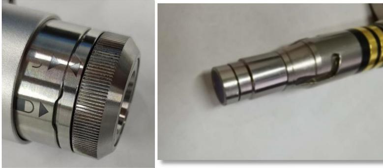
4.2 QBH 处于开锁状态（箭头指向开锁标识），光纤插头红点对准 QBH 端面红点插入到位；
