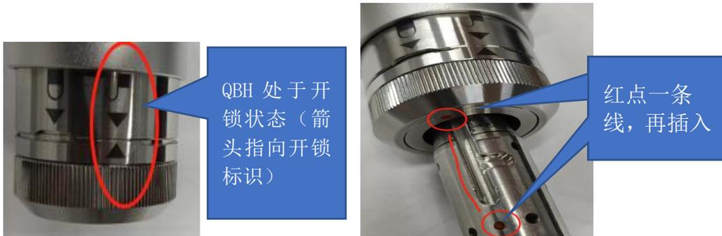
4.2 顺时针旋转 QBH 接头上带锁标识的环，直到 QBH 处于关锁状态（箭头指向关锁标识），最后扭紧锁紧环即可。
