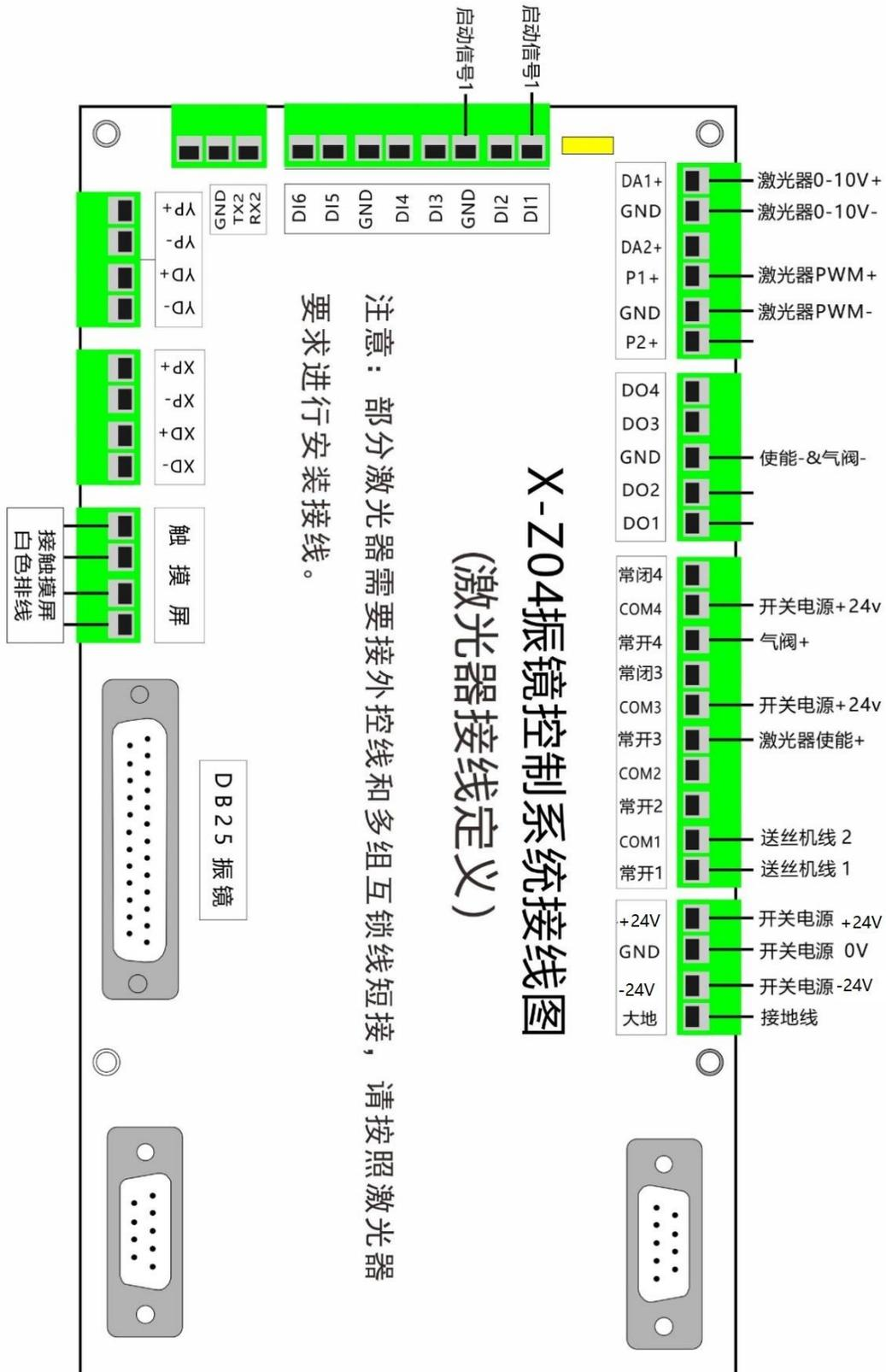
◎ **激光器连接注意事项：**部分激光器在外控状态出光需要进行短接互锁和给其中一根外控线供电，请认真阅读激光器接线说明书。
