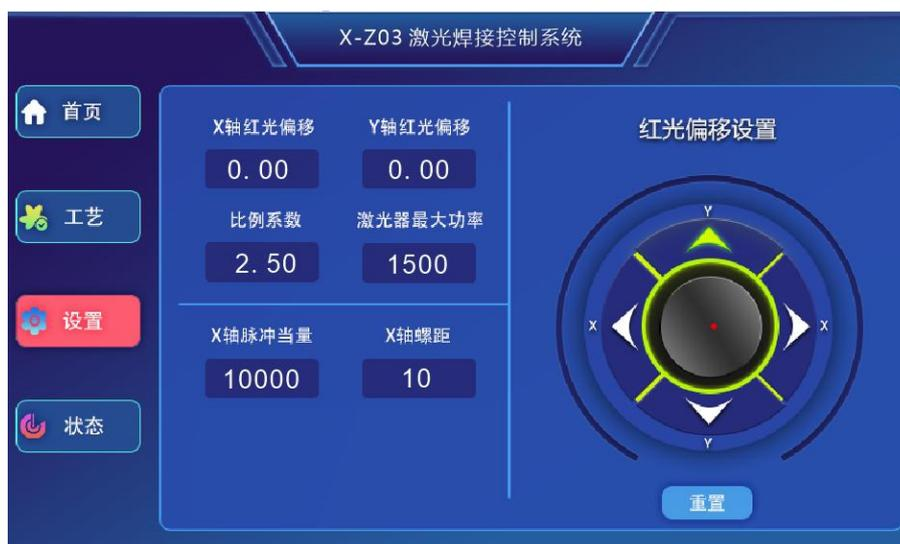
(1) X 轴、Y 轴红光偏移值： X-Z04 激光焊接控制系统同时支持 X 轴和 Y 轴调整，系统支持振镜开启或关闭两个状态下进行调整，根据客户习惯选择。重置按键为振镜电机回零按键。
